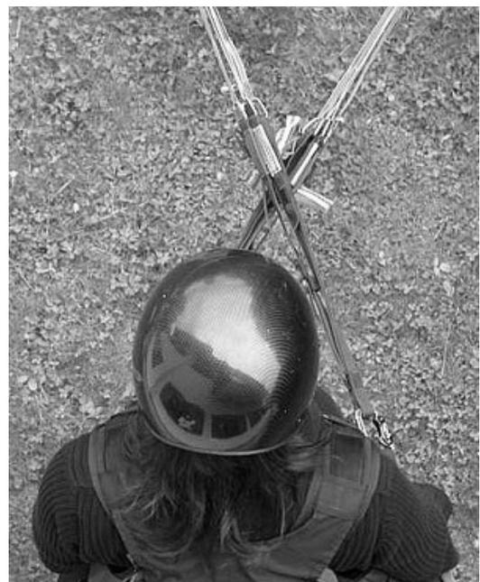
Der **Linksausdreher** steht zum Gleitschirm zugewandt, nimmt beide A- Tragegurte in die Hand, hält diese zuerst parallel zueinander und dreht diese **um 180 Grad nach links** (die **Bremse zeigt nach oben**).
